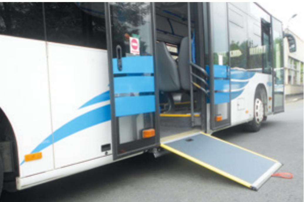
Le rampe di accesso DH-BRM... sono progettate per assistere i passeggeri su sedia a rotelle, i genitori con un passeggino, o persone con mobilità ridotta ad entrare ed uscire dal bus in modo sicuro e confortevole.
