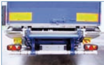
REP/4: 2 cilindri di sollevamento + 2 cilindri di rotazione e inclinazione automatica
