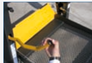
INTERRUPTORE PER SALITA E DISCESA SOLLEVATORE INSTALLATO SU PARAPETTI
